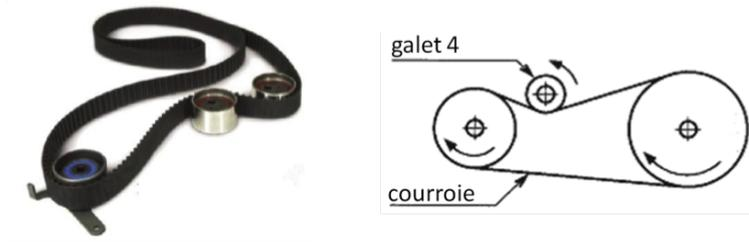
Le système permettant de déplacer le galet 4 afin de tendre la courroie est représenté sous la forme du schéma cinématique suivant
