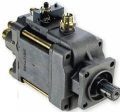
Dans le cas des pompes à pistons axiaux, les pistons sont logés dans un barillet lié à l'arbre d'entrée.
